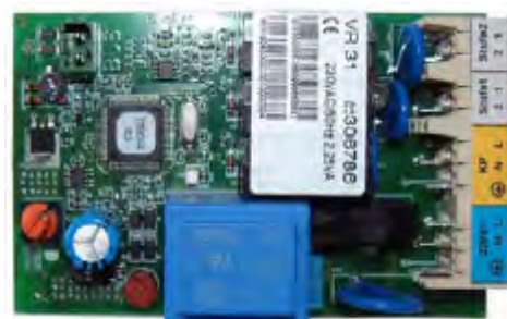
VR 31 Коммутатор для котлов со ступенчатым изменением мощности
